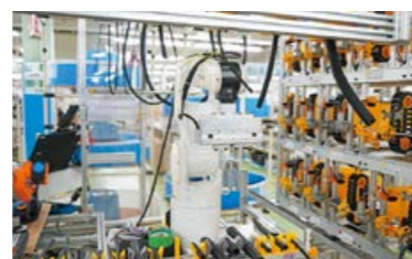
▲自社開発したロボット。設計画面に基づき、必要な部品を迅速に提供してくれる
