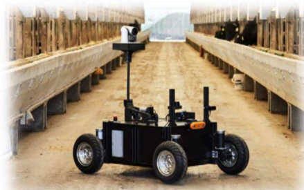
リアルタイムな牛の遠隔視認を可能にする牛舎内の見回りロボット
