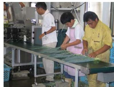
自動下葉取り・洗浄専用機から出てきたネギの中から不要な部分を取り除いていく。
