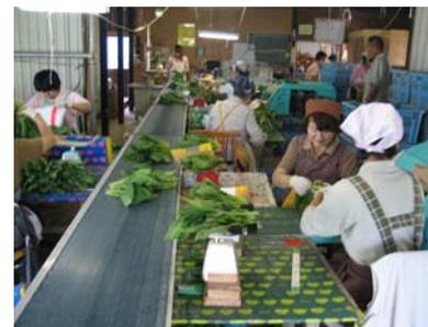
ベルトコンベアーの周りには健常者が、黄葉取りの最終的な点検とともに、規格の選別と計量を行なう。
