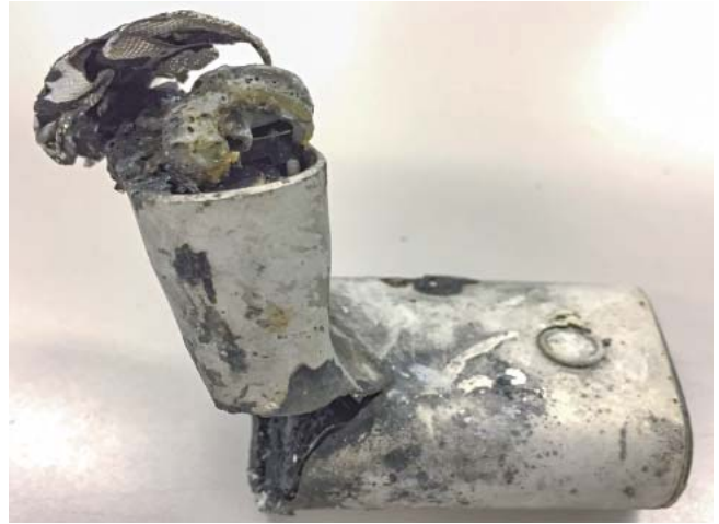
プラスチックの再商品化中に発火の原因となった加熱式タバコ 出展：「(公財) 日本容器包装リサイクル協会」
