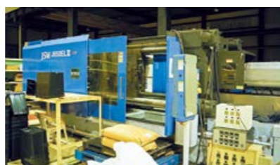
▲テスト成型機は使用する用途に応じて複数台設置しており、2色成型金型にも対応している。
