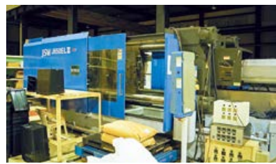
▲テスト成型機は使用する用途に応じて複数台設置しており、2色成型金型にも対応している。
