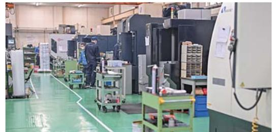
▲金型を加工する機械「マシニングセンタ」が立ち並ぶ工場内の様子
