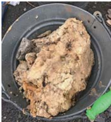
▶下水道に詰まった油脂類の塊
