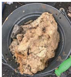
▶ 下水道に詰まった油脂類の塊
