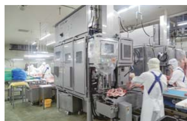
▲大隅では唯一、県内でも数か所には導入されていないという豚肉の上腕骨と肩甲骨の自動脱骨機械
