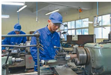
▲技能検定の普通旋盤では、100分の1mmの精度とスピードが求められる。検定は前後期の年2回行われ、現在は前期試験に向けて取り組んでいる。
