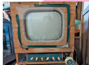
昭和31年、輝北町の鶴田さんお手製のテレビ。県内で初めてテレビ電波を受信した
