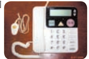
緊急通報装置
