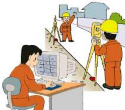
測量の基礎となる図根点（基準点）を設置し、各筆の土地の境界の測量を行います。また、その結果を基に正確な地図（地籍図）を作るとともに、各筆の面積を計算で求めます。
