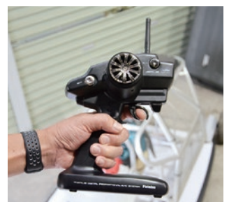
▲送信機で散布のタイミングなどの設定もできる。
