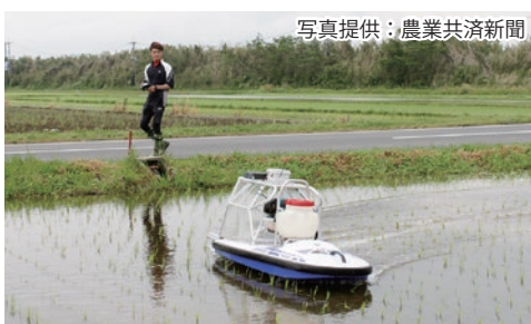
▲ボートの全長は 1.7m。薬剤タンクの容量は 8L で、1.6ha の散布が可能。
