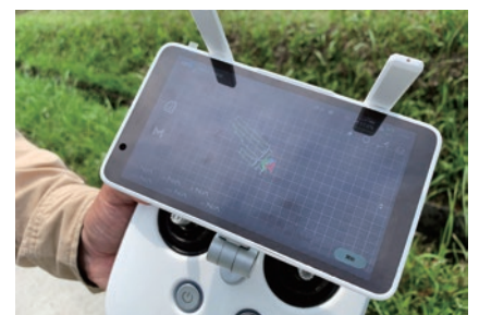
▲手元の画面で散布の有無やルートを確認しながら作業を行える。
