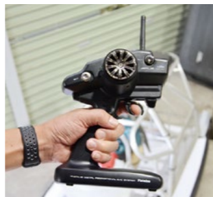
▲送信機で散布のタイミングなどの設定もできる。
