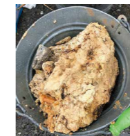
▶下水道管に詰まった油脂類
