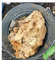
▶下水道管に詰まった油脂類
