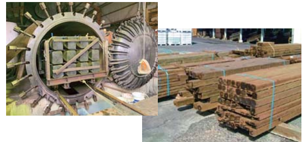
▲「O&Dウッド処理システム」工程の一部。タンクに入れた木材に防腐加工を施し (写真左)、薬剤を定着させるための養生を行う (写真右)。
