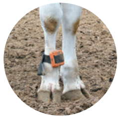
▲牛の足に装着した送信機 送信機から受信機へ毎時間データを送信。歩数情報や発情開始時間などをリアルタイムで把握
