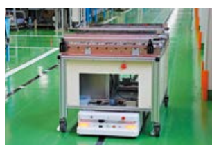
▲床の線や二次元コードを読み取りながら、梱包された商品を昇降機で運ぶ搬送機
