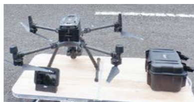
▲測量用ドローン。操作技術は必要になるが、人が立ち入ることのできない場所や難しい場所でも測量が可能。
